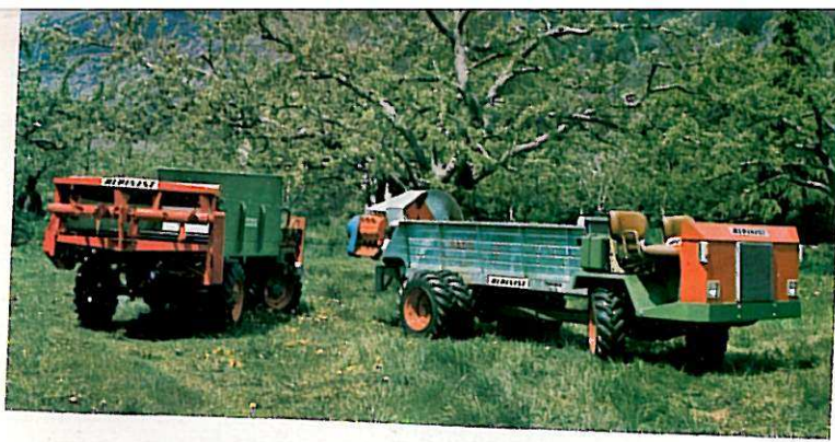
Breitmiststreuer nach hinten und Hangseitenstreuer seitlich
